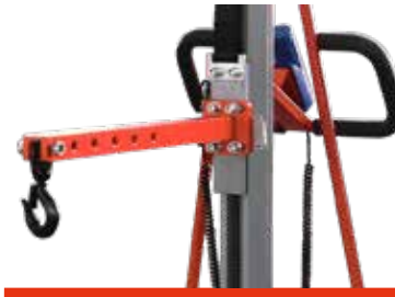
Tragarmausleger Art.Nr.: El-Ausleger L, mm: 510 B, mm: 85 H, mm: 145 (inkl. Haken) Gewicht, kg: 4
