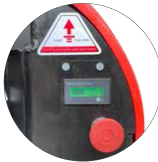
Batterieladestand- und Betriebsstundenanzeige mit Not-Aus-Knopf
