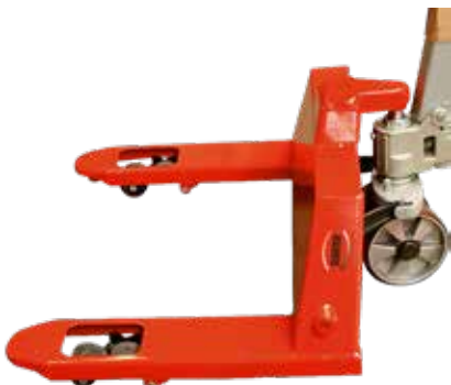
Gekürzte Gabelzinken mit breiter Gabeltragbreite
