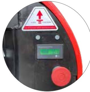
Batterieladestand- und Betriebsstundenanzeige mit Not-Aus-Knopf
